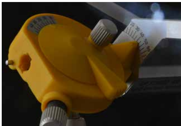
Fig.5 Scala graduata per regolare inclinazione cesta condilare.
