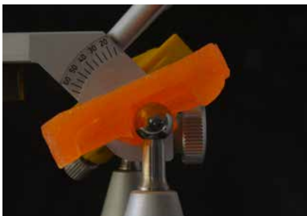
Fig.3 Cesta articolare duplicata e sezionata con particolare del condilo non a contatto della cesta.
