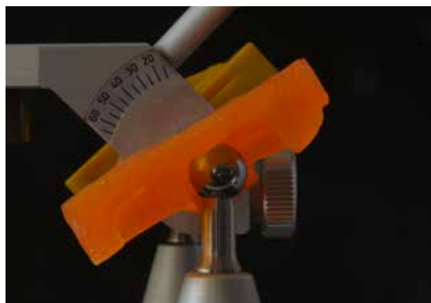
Fig.4 Cesta condilare duplicata e sezionata con particolare del condilo a contatto della cesta.
